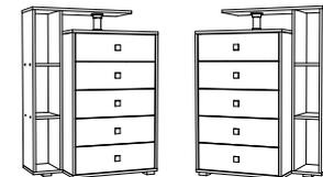
**ВНИМАНИЕ** После установки всей конструкции рекомендуется стянуть между собой все секции межсекционной стяжкой, предварительно выровняв их между собой. Отверстия делаются по месту сверлом диаметром 5-6 мм.
